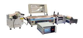
MSK-RR-350 是一款自动卷对卷系统,带有自动张力控制盒纠偏系统,最大上卷宽度 350mm。此款设备涂布适合和本公司单片涂布机(MSK-AFA-L1000)配合,DIY 卷对卷涂布机。
